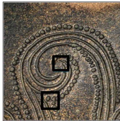
16. a kép: A pásztázó mikroszkonda segítségével 2x2 mm 2 -es elemtérkép felvételére is sor került a hajdúsámsoni kard pengéjének díszítésén.
